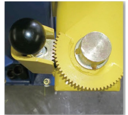
La traba de seguridad está soldada al interior de la columna
