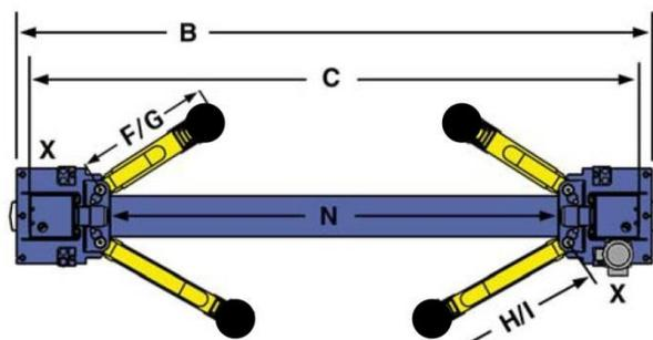
AVISO: Unidad de Energía puede ser colocada en ambos puntos marcados con X.
