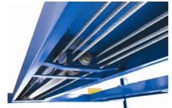
Engrasadores están situados en cada eje de la polea y polea para que el mantenimiento de lubricación no sea problema.
