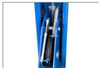
Un sistema secundario de refuerzo actúa como un dispositivo de seguridad en el improbable caso de un fallo en el cable.
