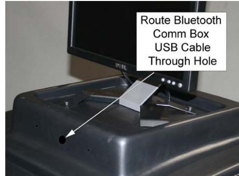
18. Monte la caja de comunicación Bluetooth en parte frontal de la cubierta plástica, justo por debajo del monitor.
